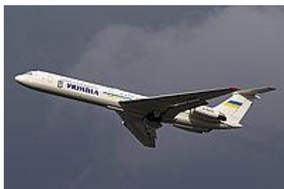
Самолёт Ил-62 и его модификация Ил-62М предназначены для перевозки пассажиров, а также грузов, габариты которых не превышают указанных в таблицах. Грузы, почта и багаж пассажиров располагаются россыпью в трех герметичных багажно-грузовых отсеках под полом пассажирского салона и одном негерметичном отсеке в хвостовой части самолёта.
