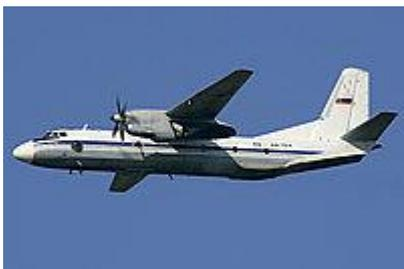
Грузовой самолёт Ан-26 и его модификация Ан-26Б предназначены для перевозки крупногабаритных и тяжеловесных грузов, колёсной техники и грузов, размещённых на поддонах. Максимальная коммерческая загрузка — до 5,5 т.
