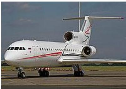
Самолёт Як-42 используется для перевозки пассажиров и грузов при максимальной коммерческой загрузке 14,5 т. Грузы на самолёте Як-42 располагаются в восьми контейнерах в переднем и заднем грузовых отсеках. В переднем грузовом отсеке располагаются шесть контейнеров АК-0,7, а в заднем два. Максимальные габариты груза, перевозимого в контейнере АК-0,7: 1,1×0,7×1,0 м. Внешний вид и габаритные размеры контейнера даны в разделе «Грузовые и багажные контейнеры».
