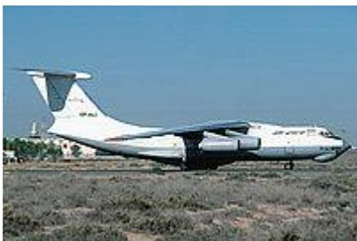
Грузовой самолёт Ил-76Т предназначен для перевозки крупногабаритных и тяжеловесных грузов, колёсной и гусеничной техники и грузов, размещённых в контейнерах и на поддонах. Максимальная коммерческая загрузка — 40 т.
